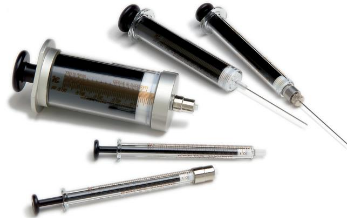
Microsiringhe per l'iniezione di campioni gassosi
