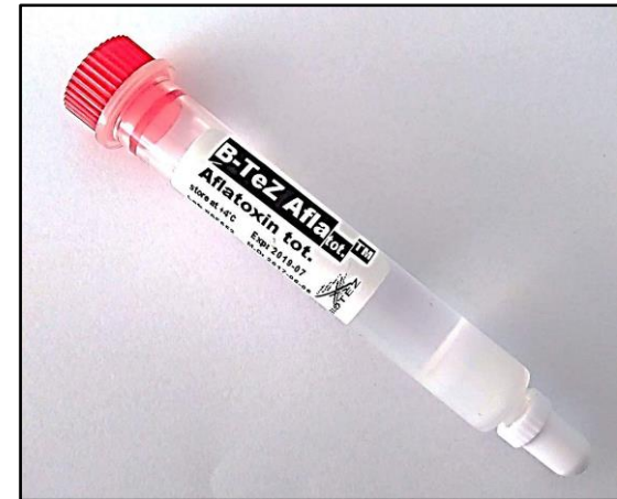
Colonna di immunoaffinità per l'estrazione di aflatossine da campioni alimentari
