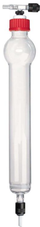
Colonna per cromatografia preparativa mediante "flash-chromatography"
