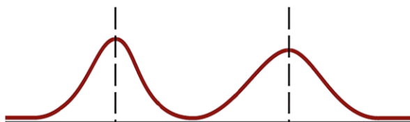
Miglioramento della separazione ottenuto agendo sulla velocità di migrazione degli analiti (ovvero sui tempi di ritenzione)
